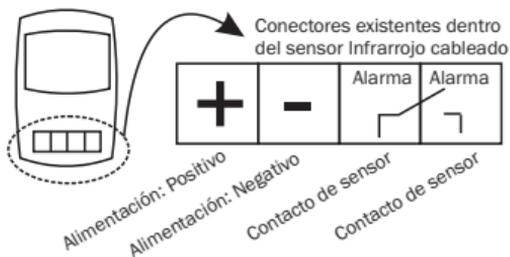
**Al utilizar sensores cableados, retire el jumper correspondiente al sector utilizado.**
